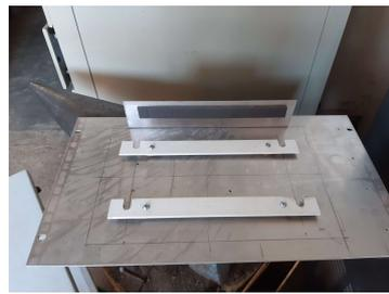
Una volta rimosso il ponte si può evidentemente rimuovere, se occorre, la piastra porta cavità per eventuali operazioni di manutenzione/taratura.
