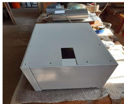
La piastra di supporto è collegata a terra del contenitore come pure la scatola del ponte. Occorre predisporre un cavo di terra da collegare ad opportuno bullone interno visibile in basso dal lato cavità, rimuovendo il posteriore e facendolo uscire dalla feritoia assieme al cavo del 220v.. Il sistema assemblato compreso i cavi di collegamento, viene fuori agevolmente (un poco di traverso) svitando le 4 viti prima citate.
