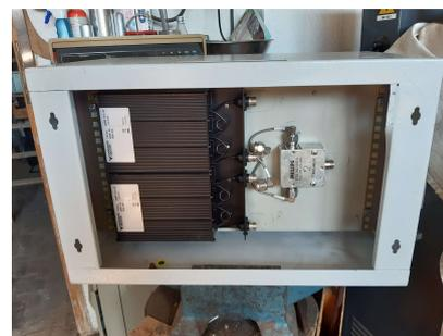
Il ponte è tenuto agganciato alla piastra di supporto con un sistema ad incastro e tenuto fermo da una staffa al L posizionata in alto e avvitata alla piastra di base. Se occorre rimuovere il ponte bisogna svitare le due viti in alto della staffa al L e sollevare verso l'alto il ponte per circa 2 cm il che permette lo sgancio dalle asole fisse. Occorre prima svitare i coassiali e il collegamento di terra e sfilare la presa 220.
